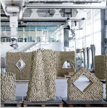
ETH-Forschende haben ein Druckverfahren für Erdmaterialien entwickelt, das ohne Zement auskommt
